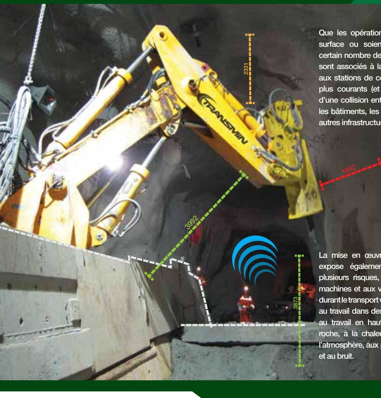
Que les opérations se déroulent en surface ou soient souterraines, un certain nombre de dangers potentiels sont associés à la brisure de roches aux stations de concassage. Un des plus courants (et coûteux) est celui d'une collision entre le brise-roche et les bâtiments, les équipements et les autres infrastructures environnantes.
